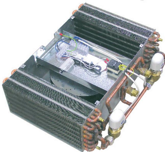
Legalett 5000W lämmityslaite asennetaan perustuslaattaan. Lämmityslaitteessa on kaksi kappaletta vesi/ilmanvaihtimia sekä venttiilit, joiden ohjaamiseen käytetään yksi tai kaksi huonetermostaattia.
